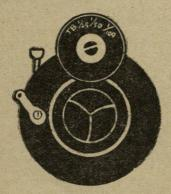
El obturador consiste, pues, en un mecanismo de relojería mediante el cual, con sólo apretar un botón o palanca, se abre la entrada de luz en el aparato fotográfico durante el tiempo requerido por las condiciones de la fotografía que se va a efectuar.
