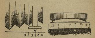
e infinito. Eso significa que al hacer la fotografía de un objeto, debemos calcular a qué distancia se halla del objetivo aquella parte del objeto que deseamos quede nítidamente grabada en la fotografía. Si esta distancia es de cinco metros deberemos poner el indicador de la escala de enfoque en la marca correspondiente a 5 metros.
