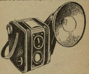
mediante un cable, y lleva consigo una pila eléctrica, y que mediante un mecanismo muy simple se enciende la lámpara en el preciso momento en que abre el obturador del aparato.
